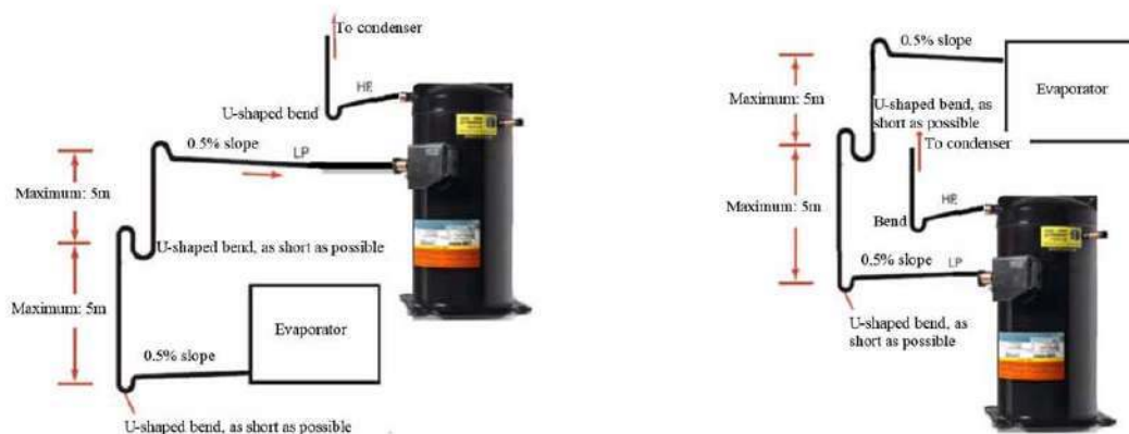
Рис. 5 Установка обратного потока масла
